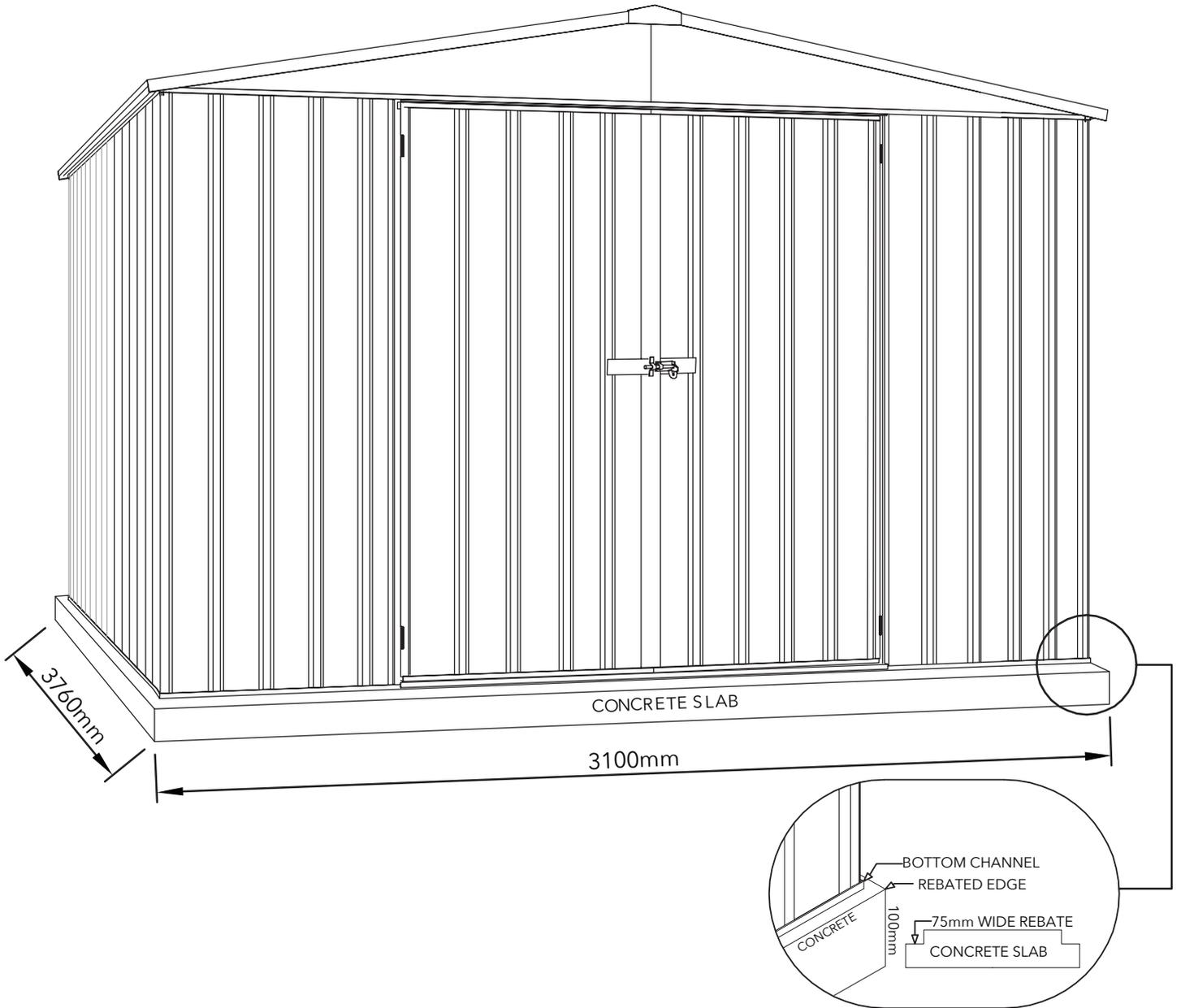
コンクリートスラブを敷設するときは、周囲に25mmの深さのリベートエッジがあることを確認します。これは、小屋の底から水が出るのを助けます。
