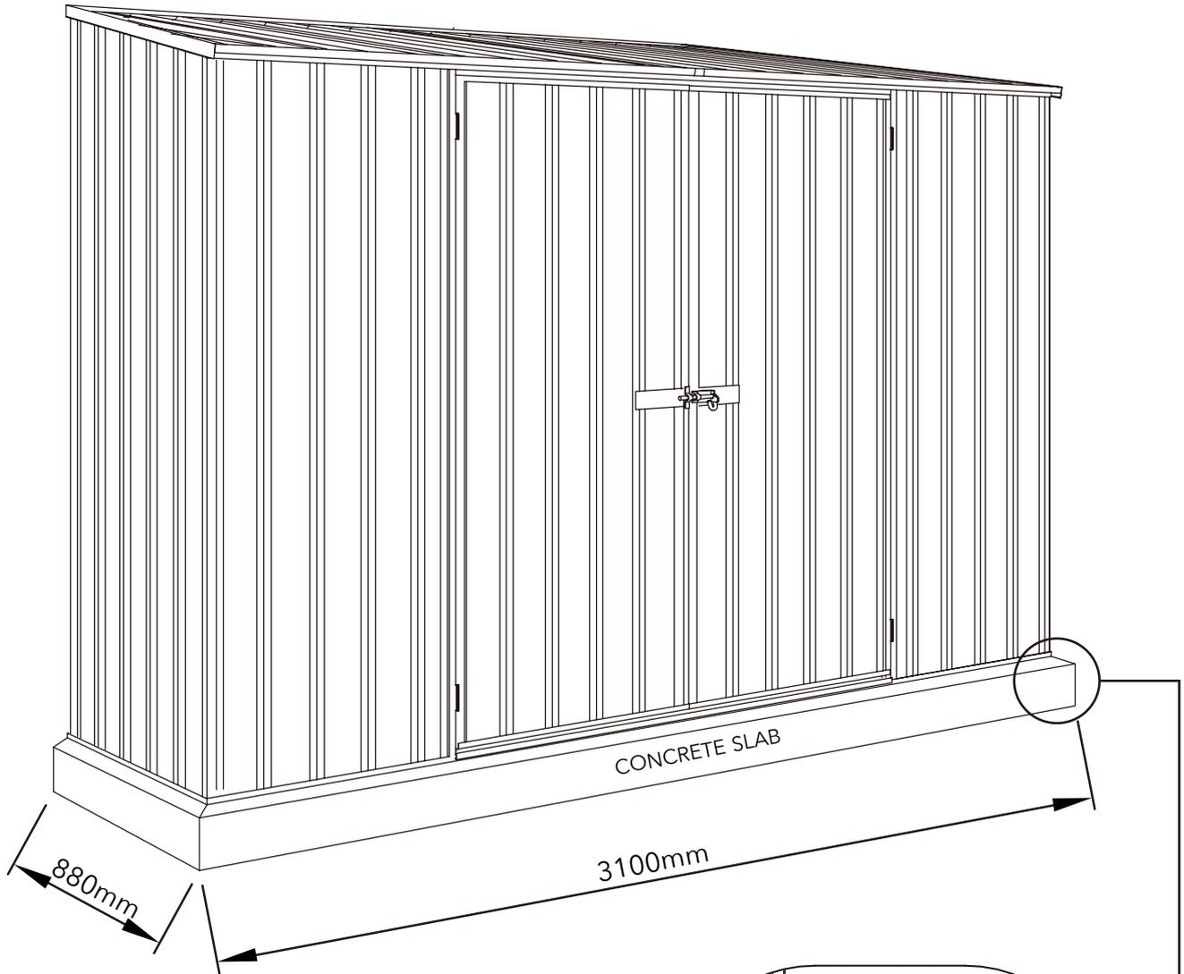
コンクリートスラブを敷設する際、周囲に25mmの深さのリバートを設けてください。これは、小屋の底面から水が抜けるのを助けるためです。
